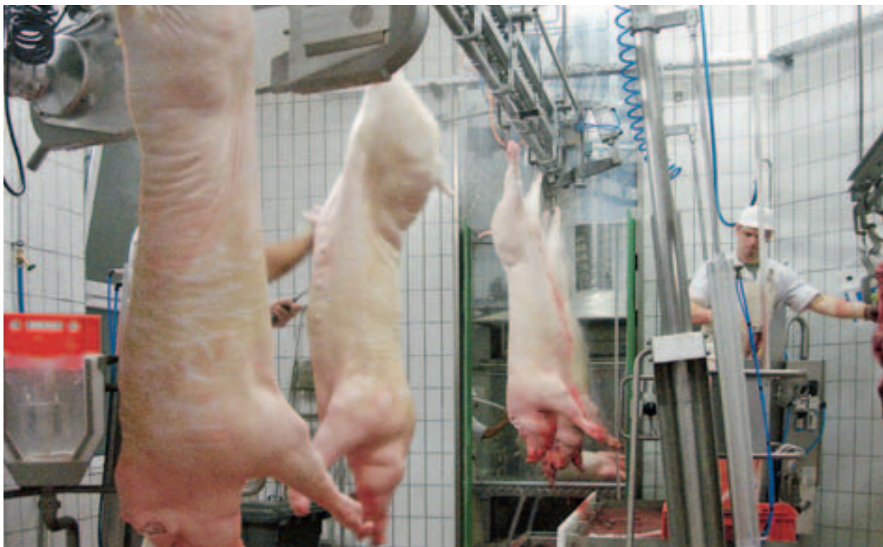
In der Schlachtung hat sich die lineare Anordnung der Produktionsschritte bewährt. So lassen sich kreuzende Wege und daraus entstehende Kreuz-Kontaminationsgefahren von Anfang an verhindern. | Foto: egs
