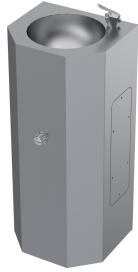
aus Edelstahl Werkstoff 1.4301, Oberfläche gebürstet Ra < 0,8 µm, für reine Räume und Hygienebereiche wie Personalschleusen, vollverschweißter Korpus aus Edelstahl mit angeschrägten Ecken, Oberplatte mit einem runden Edelstahlbecken sowie einer Trinkarmatur mit einstellbarem Volumenstrom (unabhängig vom Eingangsdruck), Wasseranforderung erfolgt über einen Selbstschlussdrucktaster zur Kniebetätigung, Unterbau geschlossen mit beidseitigen Revisionsöffnungen
