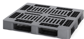
Variante: PAL_H3-5_OS ohne Sicherungsrand 2 Quer- und 3 Längskufen, nicht verschweißt
